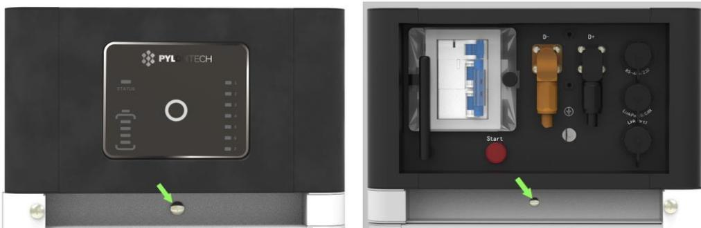
Y desmantelar la cubierta de protección de los terminales de energía.
