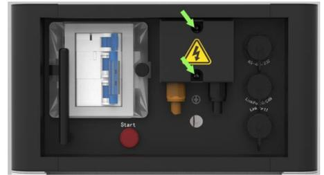
5.2.1.3 Desmontar el cable de alimentación **D+** y **D-**, el cable de comunicación y el cable de tierra si es necesario.
